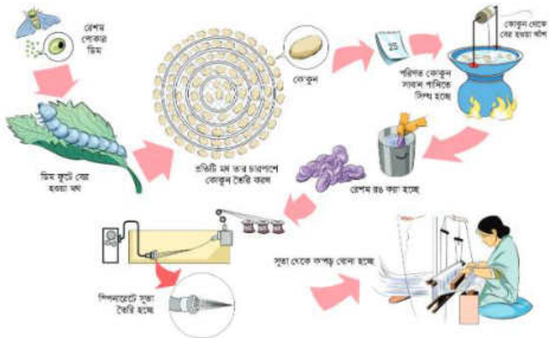
চিত্র ৬.০৪: রেশম তন্তু থেকে সূতা তৈরি
