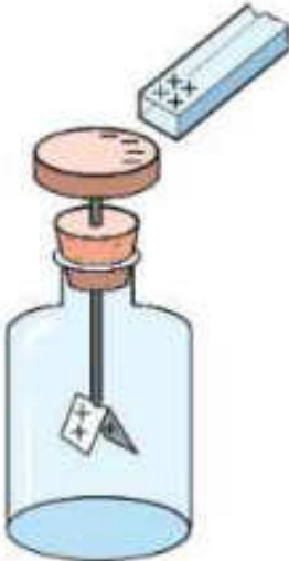
চিত্র 10.08: ইলেকট্রোস্কোপে চার্জের উপস্থিতির কারণে সৃষ্ট ধাতব পাত পরস্পর থেকে সরে যায়।
