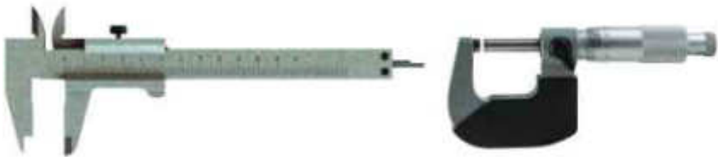
চিত্র 1.07: চিত্রটিতে ভার্নিয়ার স্কেলযুক্ত স্লাইড ক্যালিপার্স এবং একটি স্ক্রুগেইজ দেখানো হলো।
