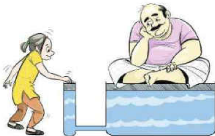
চিত্র 5.16: হাইড্রলিক প্রেসে ভাপ দিয়ে একটি মানুষকে উপরে তোলা।
