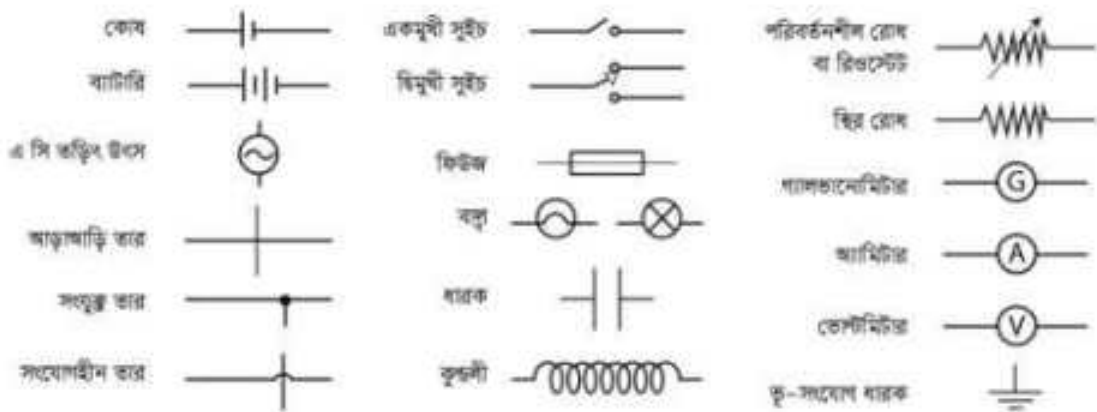
চিত্র 11.07: সার্কিট বা বর্তনীতে ব্যবহৃত হয় এ রকম কিছু প্রতীক।
