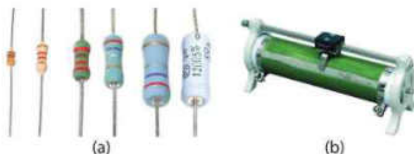
চিত্র 11.06: (a) স্থির এবং (b) পরিবর্তী রোধ
